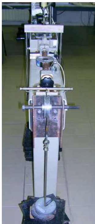
Figura 1 Macchina di taglio durante l'esecuzione di prove a controllo di carico
