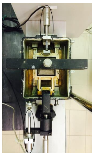
Fig. 1 – Vecchia e nuova posizione dei trasduttori di spostamento orizzontale.
