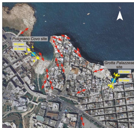
Figura 3: Direzioni principali di moto (Pellicani et al. , 2014): mareggiate (in giallo) e microtremori (in rosso).
