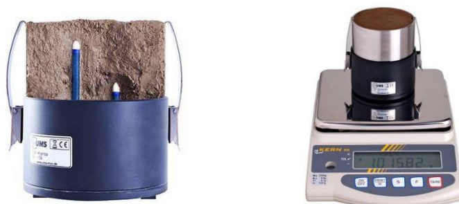
Figura 2 – Apparecchiatura HYPROP: il dispositivo, costituito dal sensore di pressione (nero) sormontato dal campione di suolo contenuto nell'anello di acciaio, in cui sono inseriti i tensiometri (a sx), poggia sulla bilancia da laboratorio (a dx); i risultati delle misure sono esposti in forma grafica e tabellare su PC attraverso il software tensioVIEW.
