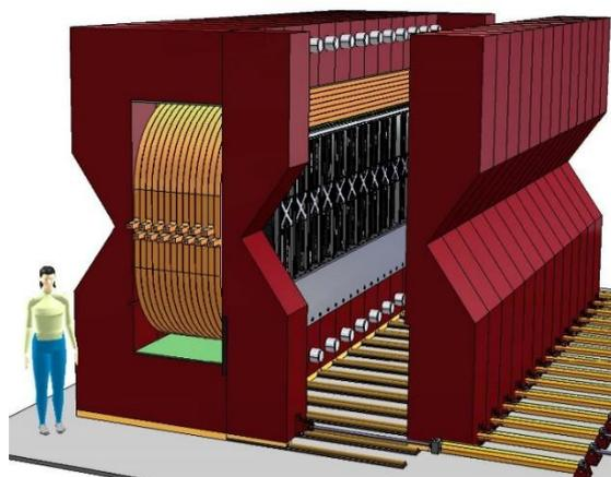
Figura 2: Magnete usato nell'esperimento SHiP, elemento fondamentale del rivelatore SND
