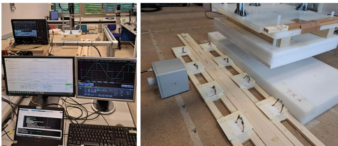
Figura 1. Sistema prototipale DEXTER: sistema di movimentazione e stazione di controllo con misurazione del campo magnetico in corso (sinistra); schermature elettromagnetiche e sonda di campo (destra).
