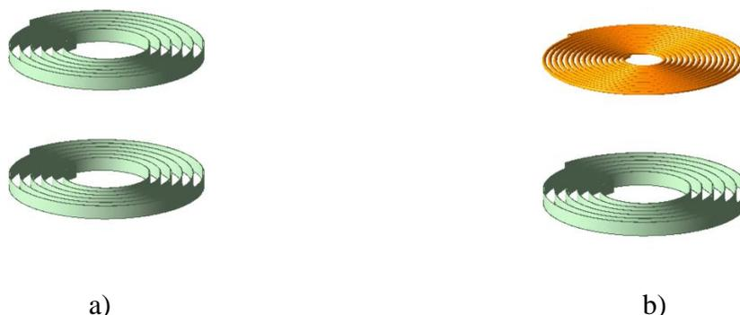
Figura 1: sistema WPT con a) due bobine superconduttrici e b) bobina trasmittente superconduttrice e ricevente di rame a temperatura ambiente.
